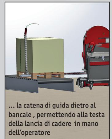
... la catena di guida dietro al bancale, permettendo alla testa della lancia di cadere in mano dell'operatore
