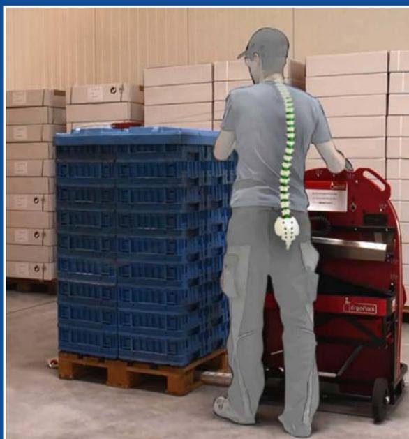
Il carico della schiena durante la reggiatura di bancali. La reggiatura manuale con un manico della scopa in confronto alla reggiatura con una reggiatrice ergonomica per bancali.
