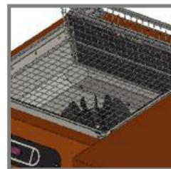
L'altezza del piatto retinato è stata aumentata per proteggere il flap del polmone del calore a vantaggio della manutenzione da parte dell'operatore.
